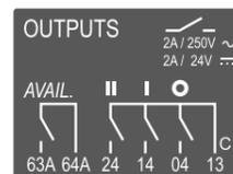
Schließen Sie das Produkt mit Kabeln 1,5 bis 2,5 mm<sup>2</sup> an.
