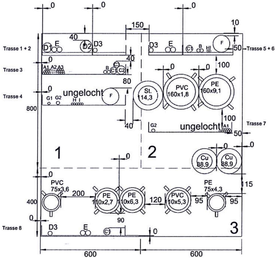
**Aufbau des Probekörpers bei Deckeneinbau**
